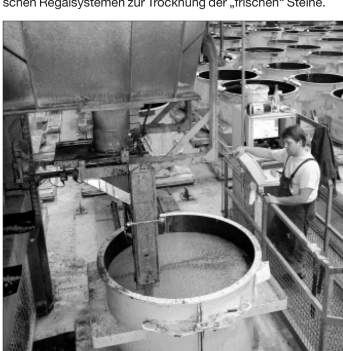
EDV-gestützt werden die Formen mit selbstverdichtendem Beton, einer Entwicklung von HABA mit Experten der TU München, gefüllt.
