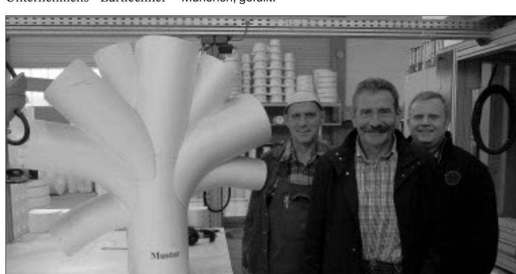
EDV-gestützt werden die Formen mit selbstverdichtendem Beton, einer Entwicklung von HABA mit Experten der TU München, gefüllt.
