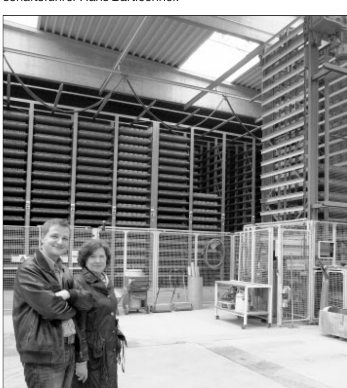
Rund 5000 Quadratmeter Pflastersteine können täglich im HABA-Werk Tüßling gefertigt werden; im Bild Werkleiter Rainer Dachsberger und Gisela Bartlechner vor den automatischen Regalsystemen zur Trocknung der „frischen“ Steine.
