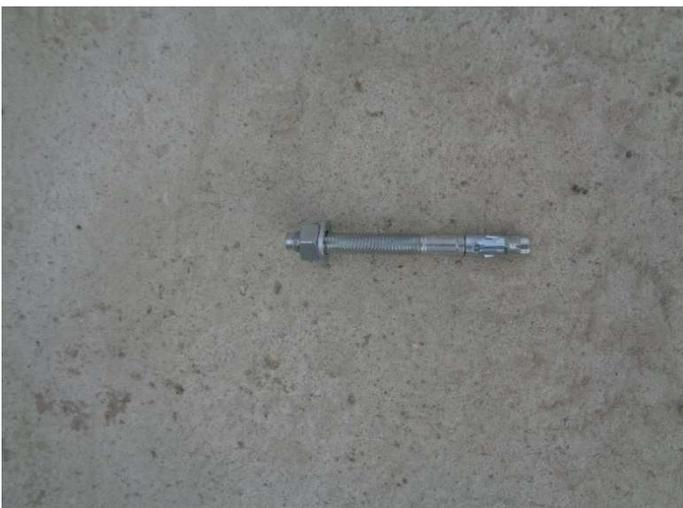
Schlaganker M12 / M20 L = 120 und Schrägbaustützen benötigt man um offene Bauwerksteile auszurichten
