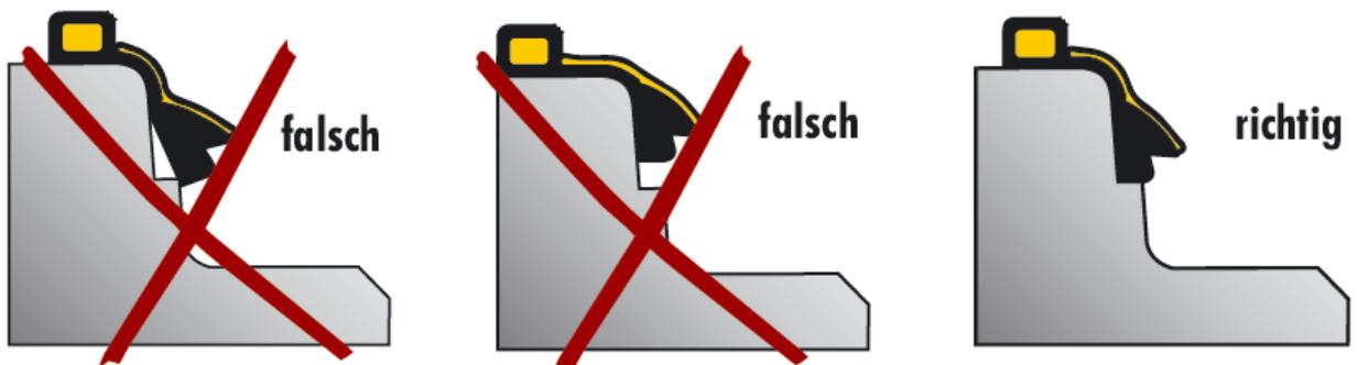
Vor Montage der SR-M den Spitzend- und Muffenbereich reinigen.
