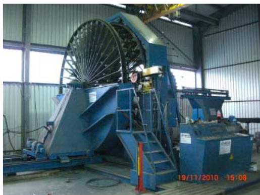
Fot. 4. | Maszyna do spawania zbrojenia
