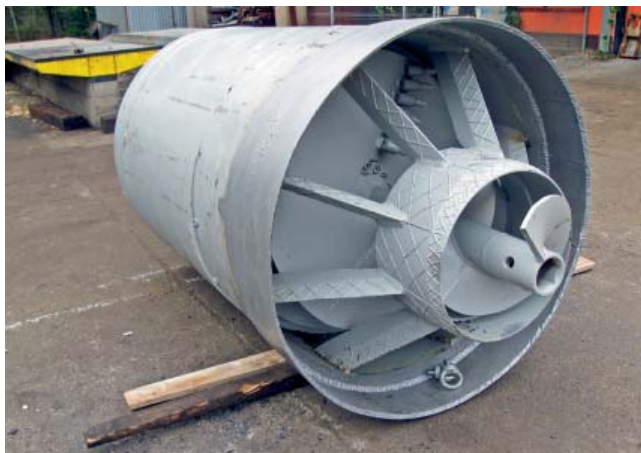
Fot. 4. Maszyna startowa DN508 ze specjalnym kołnierzem osłaniającym
