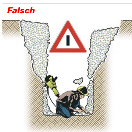
Gefahr: Künette nicht abgesichert
