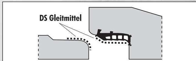
Die DS DENSOCRET® BL-T Rohrverbindung ist mit den baustellenüblichen Hilfsmitteln problemlos montierbar. Bei der Rohrverlegung ist DIN EN 1610 sowie das ATV-Arbeitsblatt A 139 zu beachten.
