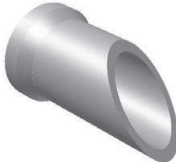
Element skarpowy wylot nachylenie 1 : 1,5
