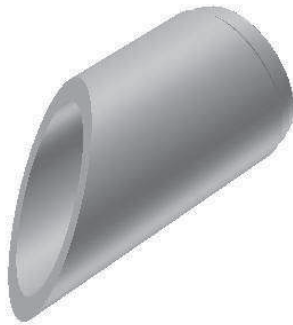
Element skarpowy wlot nachylenie 1 : 1,5
