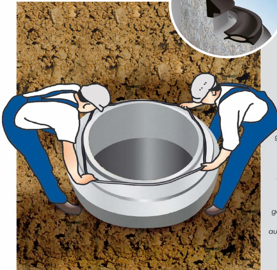
**1.** Dichtung – Gleitmantel nach oben und außen zeigend – auf das saubere Spitzende aufziehen, Vorspannung durch mehrfaches Ziehen an verschiedenen Stellen gleichmäßig verteilen und auf richtigen Sitz der Dichtung an der Schulter achten.
