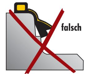
**2.** Schachtring zentrisch und gerade hängend aufsetzen und aufgleiten lassen.
