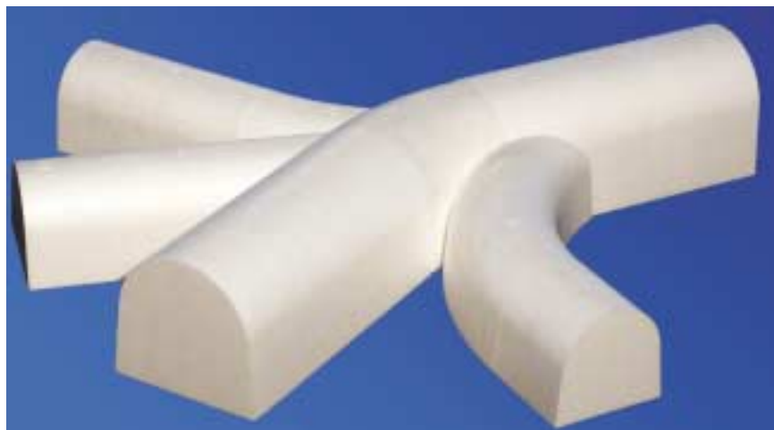
4 Styropor-Gerinneabbild – aus einem Standardsortiment von Polystyrol-Formstücken werden die Negativabbildungen der späteren Gerinne zusammengefügt
