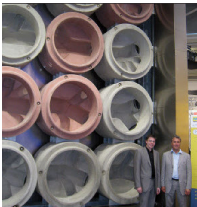
Dank moderner Fertigungstechnologie werden Spezialgerinne in unterschiedlicher Geometrie in Schächten bereits passgenau im HABA-Werk vorgefertigt. – Foto: ede
