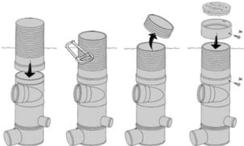
von Hand mit einer Eisensäge, die Revisionöffnung der Erdgleiche anpassen. Das Rohr wird direkt auf das WFF-Gehäuse gesteckt und mit den beigegeführten Edelstahl-Schrauben durch die vorhandenen Löcher verschraubt, bevor der WFF in die Erde gesetzt wird.
