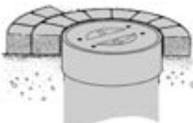
*Der Abschlußring ermöglicht eine Beipflasterung. Der darin versenkte Deckel läßt sich mit einer Linksdrehung entriegeln und herausnehmen.*
